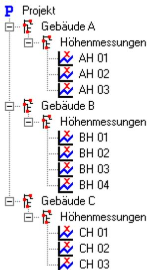
Für jede der 10 Höhenmessstellen 'AH 01', 'AH 02', ..., 'CH 03' soll nun die Geschwindigkeit der Messwertänderung berechnet werden. Berechnungsbasis soll der Zeitraum von einer Woche sein. Die Berechnungsergebnisse sollen in der Einheit 'mm/Jahr' angezeigt werden.
