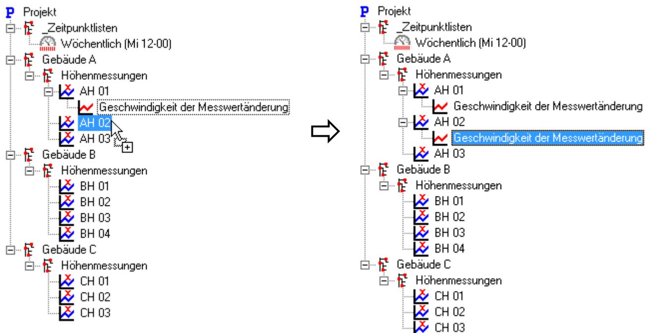
Da die Berechnete Messstelle 'Geschwindigkeit der Messwertänderung' in der Berechnung den unmittelbar übergeordneten Knoten verwendet, wird dieser Bezug von GKS Pro beim Kopieren automatisch angepasst. Ohne dass wir eine manuelle Anpassung durchführen müssen, bezieht sich die Kopie sofort auf die übergeordnete Höhenmessstelle und liefert für diese die Geschwindigkeit der Messwertänderung.
